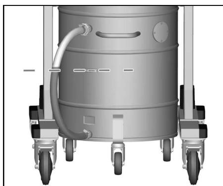
**Aviso:** A marcação vermelha na mangueira de escoamento indica o nível de enchimento máximo permitido.
