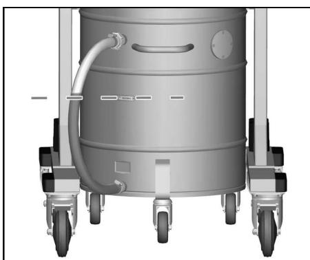
**Indicație:** Marcajul roșu de la furtunul de aspirație indică nivelul de umplere maxim.
