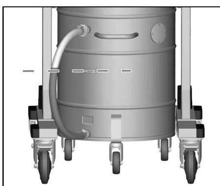
**Instructie:** De rode markering op de aftapslang geeft het maximale vulniveau weer.
