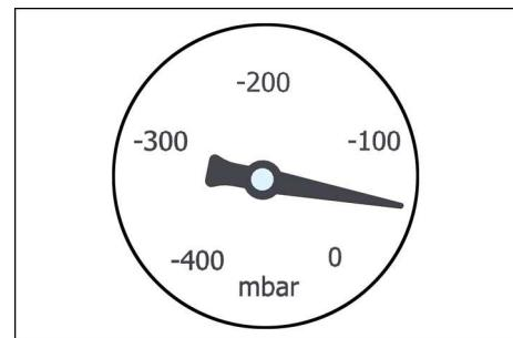
→ Якщо значення вакууму становить менше 100 мбар, слід очистити або замінити фільтр.
