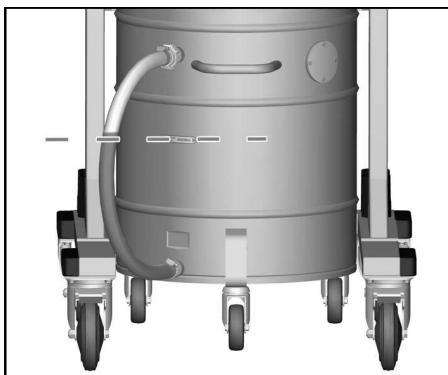
**Indicazione:** La marcatura rossa al tubo flessibile di scarico indica il livello massimo consentito di riempimento.
