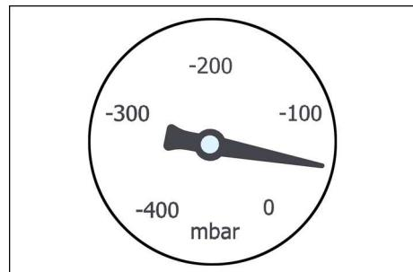
→ Vyčistite alebo vymeňte filter pri podtlaču menšom než 100 mbar.
