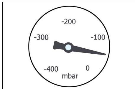
→ Filter bei einem Unterdruck von weniger als 100 mbar reinigen oder austauschen.
