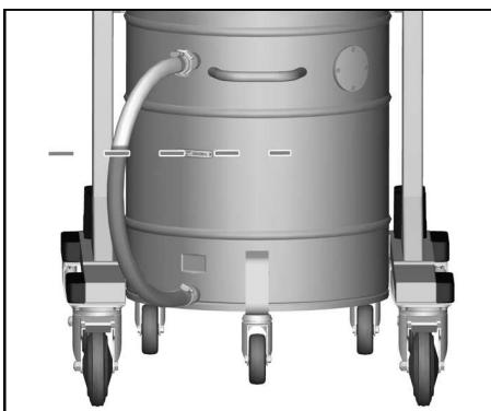
**Указание:** Червената маркировка на изпускателния маркуч показва максимално допустимото ниво на запълване.
