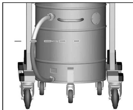
**Υπόδειξη:** Το κόκκινο σημάδι στον ελαστικό σωλήνα απορροής δείχνει τη μέγιστη επιτρεπόμενη στάθμη πλήρωσης.
