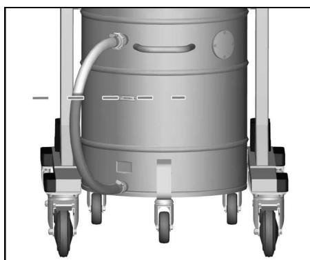
**Bemærk:** Den røde markering på aftapningsslangen viser det maks. tilladte påfyldningsniveau.
