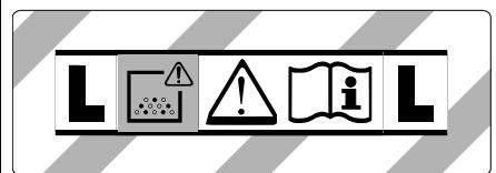
**HOIATUS:** Käesolev seade sisaldab tervist kahjustavat tolmu. Seadet tühjendada ja hooldada ning tolmukottti eemdaldada tohivad ainult asjatundjad, kellel on sobiv individuaalne kaitsevarustus. Ärge lülitage sisse, enne kui on paigaldatud terve filtrisüsteem.
