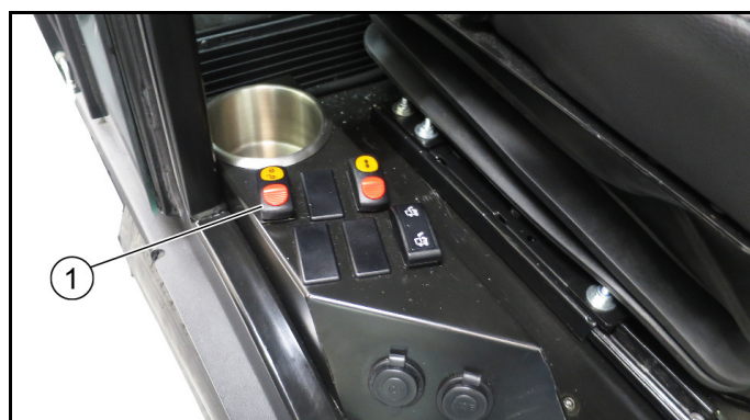
① Relä för batterifrånkoppling
