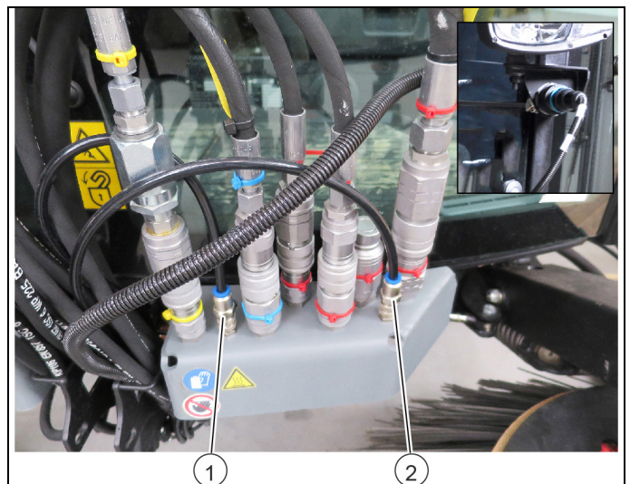
① Água de pulverização da vassoura lateral esquerda ② Água de pulverização do bocal de aspiração
