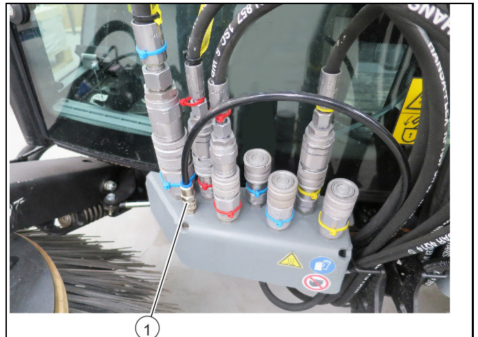
① Água de pulverização da vassoura lateral direita
