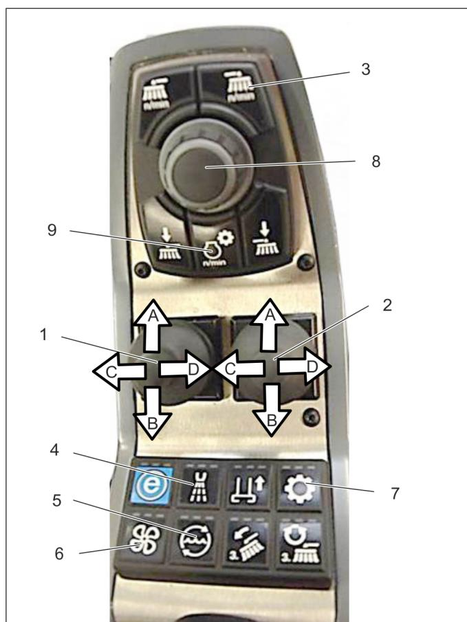
1 Upravljalna ročica škropilnega prečnika in leve roke
