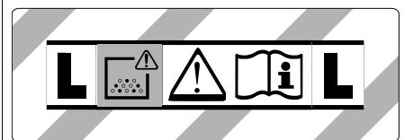
**ΠΡΟΕΙΔΟΠΟΙΗΣΗ:** Η συσκευή αυτή περιέχει σκόνη βλαβερή για την υγεία Η εκκένωση και η συντήρηση, συμπεριλαμβανομένης της αφαίρεσης της σακούλας σκόνης, πρέπει να εκτελούνται μόνο από ειδικούς, οι οποίοι χρησιμοποιούν κατάλληλο προσωπικό εξοπλισμό προστασίας. Να μην ενεργοποιηθεί, πριν εγκατασταθεί ολόκληρο το σύστημα φίλτραρίσματος.
