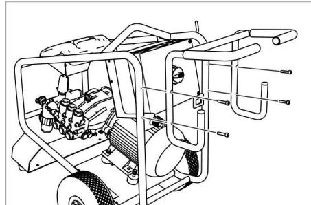
Monter forskydningsbøjlen med de fire vedlagte skruer.
