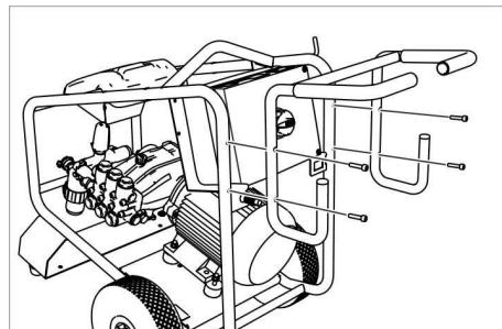
Montera skjutbygeln med de 4 medföljande skruvarna.
