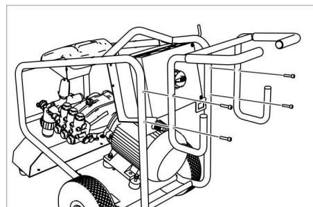
Rögzítse a tolókengyelt a készletben található csavarokkal.
