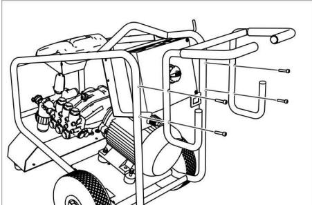
Fixer le guidon de poussée à l'aide des quatre vis jointes.
