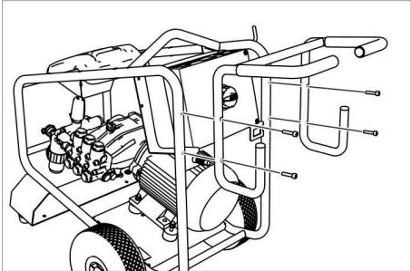
Fissare l'archetto di spinta con le quattro viti in dotazione.
