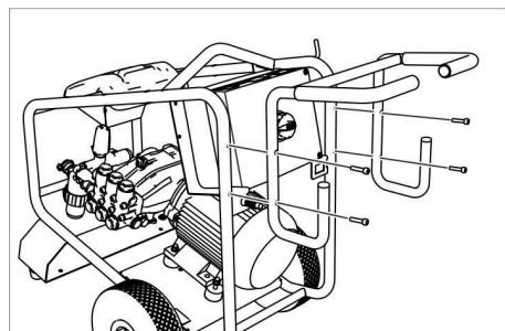
Schubbügel mit den vier mitgelieferten Schrauben befestigen.
