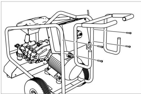
Zamocować uchwyt do prowadzenia za pomocą czterech dołączonych śrub.
