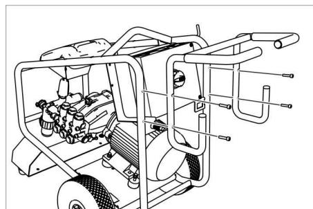
Posuvné rameno připevněte 4 přiloženými šrouby.
