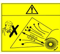
Pericol prin obiectele azvârlite în cazul funcționării cilindrului de măturare. Respectați distanța de siguranță de 3 m în față și în lateral
