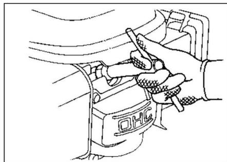
→ Skru det rengjorte eller et nyt tændrør i. Anbefalede tændrør: se de tekniske data
