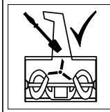
Очищать шахту выброса только с использованием моющих инструментов.
