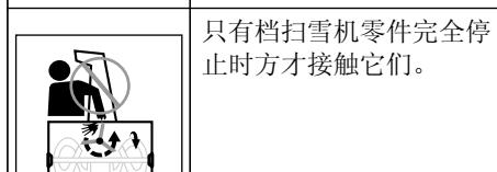
因零件转动而存在受伤危险。手脚远离转动零件。
