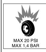
Explosionsgefahr! Maximalen Reifenluftdruck von 1,4 bar/20 PSI niemals überschreiten.
