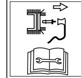
Inden der gennemføres opgaver, som f.eks. indstilling, rengøring, kontrol osv., skal maskinen afbrydes og tændrørshætten skal trækkes fra.
