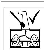
Auswurfschacht nur mit Reinigungswerkzeug reinigen.
