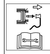
Lülitage masin enne kõiki selliseid töid nagu nt reguleerimine, puhastamine, kontrollimine jne välja ja tömmake süüteküunal välja.
