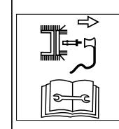
Napravo pred vsemi deli, kot so na primer nastavljanje, èišèenje, preverjanje itd. izkljuèite in izvlecite vtiè za vžigalne sveèke.
