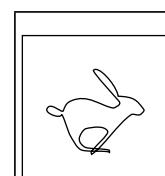
Ustawienie dźwigni gazu „szybko“
