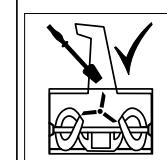
Ne nettoyer le puits d'éjection qu'avec l'outil de nettoyage
