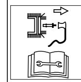
Przed wszelkimi pra- cami, np. ustawianiem, czyszczeniem, spraw- dzaniem itd., wyłączyć urządzenie i wyjąć koń- cówkę przewodu świecy zapłonowej.
