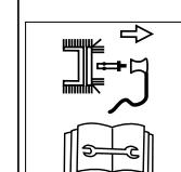
Eteindre l'appareil avant tout travail tel que réglage, nettoyage, contrôle, extinction .. et retirer la prise des bougies.
