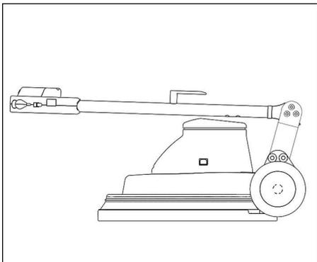
Ved 230V/60Hz varianten kan en ved transport og lagring svinge håndtaket frem.
