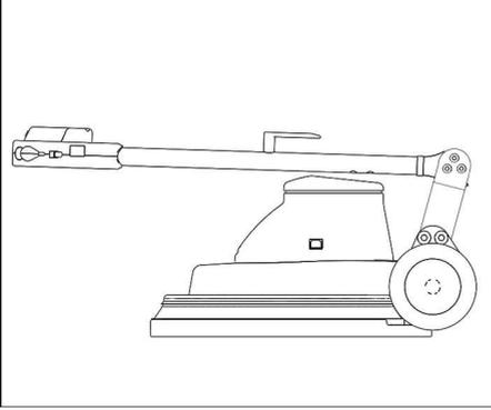
230V/60Hz modelinde, taşıma ve depolama için tutamak öne çevrilebilir.
