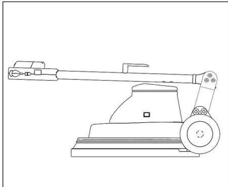
Kod izvedbe 230V/60Hz se radi transporta i skladištenja rukohvat može zakrenuti prema naprijed.
