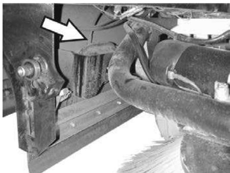
Slangetilslutning til undertryksdåsen af sidekostens sænkning
