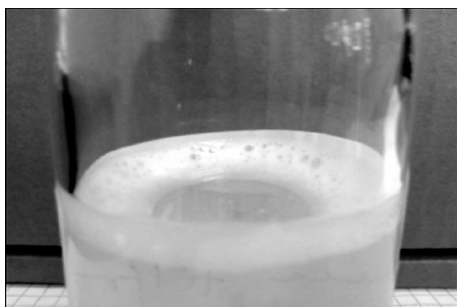
Skumbillede filter tilstoppet: tyk skumring på kanten som ikke nedbrydes.
