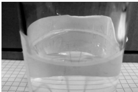
Schaumbild Filter in Ordnung: sehr dünner Schaumring am Rand, der schnell zerfällt.
