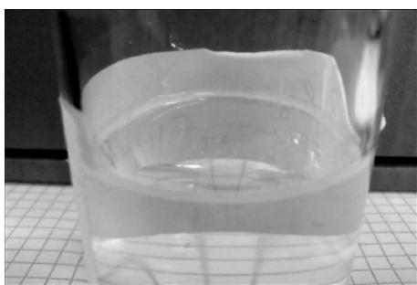
Schiuma del filtro perfetta: schiuma molto sottile ai bordi che scompare subito.
