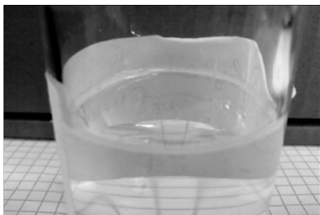
Skumdannelse filter i orden: svært tynt skumring på kanten, faller raskt sammen.
