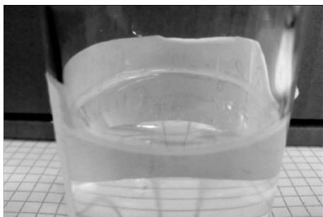
Skumbillede filter i orden: meget tynd skumring på kanten som hurtigt nedbrydes.
