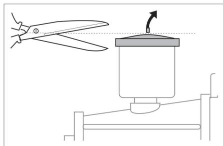
→ Pred prvým uvedením do prevádzky je nutné odrezat' hrot krytu olejovej nádrže na vodnom čerpadle.
