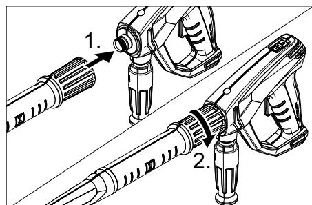
→ Csatlakoztassa a magasnyomású fúvókát a sugárcsőre.
