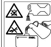
*Nu alimentați cu combustibil atunci când motorul funcționează.*
