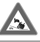
**Maximal lutning hos underlaget vid körning med upplyft sopbehållare.**
