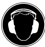
**Fare for hørselsskader.** Ved arbeid med maskinen må det absolutt brukes egnert hørselsvern.
