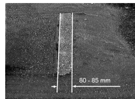
Профиль подметания должен иметь вид равномерного прямоугольника шириной 80-85 мм.
