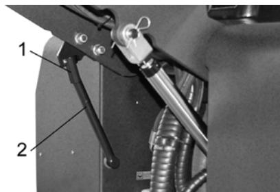
1 Держатель предохранительной штанги
