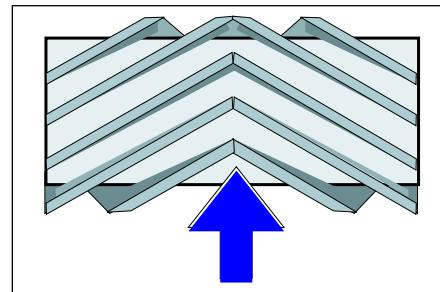
Расположение подметающего вала при установке по направлению движения (вид сверху)
