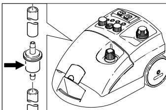
No caso de utilização de água contaminada, é possível que o filtro fique entupido. Isto faz-se notar com tempos de funcionamento da bomba particularmente prolongados ou por uma falha total do funcionamento.
