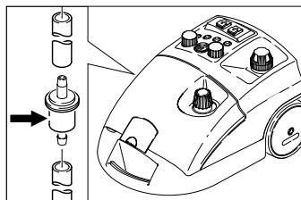
Il filtro si potrebbe otturare nel caso in cui si utilizzi acqua sporca. Tale circostanza si evidenzia quando la pompa si disattiva per lungo tempo o interrompe del tutto il suo funzionamento.
