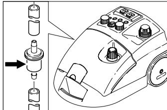
Filtret kan täppas till om förorenat vatten används. Detta märks genom att pumpen går ovanligt länge eller att apparaten inte fungeras alls.
