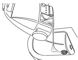
Spălați rezervorul cel târziu după fiecare a 5-a umplere.
