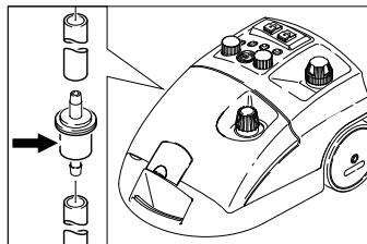
При използване на замърсена вода филтърът може да се запуши. Това се забелязва по извънредно дългото време на работа на помпата или излизането от строя на функцията.
