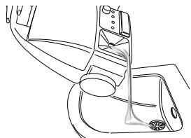
Kessel des Dampfreinigers spätestens nach jeder 5. Kesselfüllung ausspülen.
