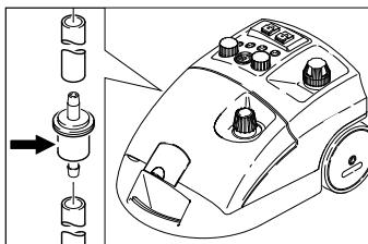
Bij gebruik van verontreinigd water kan de filter verstopt raken. U merkt dit wanneer de pomp heel lang moet lopen of wanneer het apparaat helemaal niet meer werkt.
