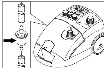
При использовании загрязненной воды фильтр может засориться. Это становится заметно по чрезвычайно длительному запаздыванию в работе насоса или по полному выходу его из строя.
