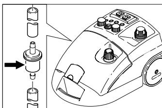
Le filtre peut se boucher si de l'eau impure est utilisée. Cela se manifeste par des durées de fonctionnement de la pompe extrêmement longues ou une défaillance totale.
