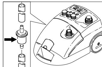
Hvis man bruger tilsmudset vand kan filtretilstoppe. Det vises idet pumpen kører længe eller svigter.
