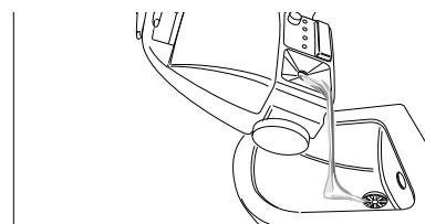
Sciacquare la caldaia del pulitore a vapore (max. 5° riempimento caldaia).
