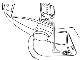
Rincer la chaudière du nettoyeur à vapeur après 5 remplissages de chaudière au maximum.
