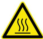
*Opasnost od opekline na vrelim površinama! Prije obavljanja radova na stroju treba pričekati da se ispušni uređaj dovoljno ohladi.*
