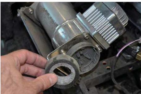
フィルターに付着した粉塵を取り除くか付属の新しいフィルターと交換を行ってください。
