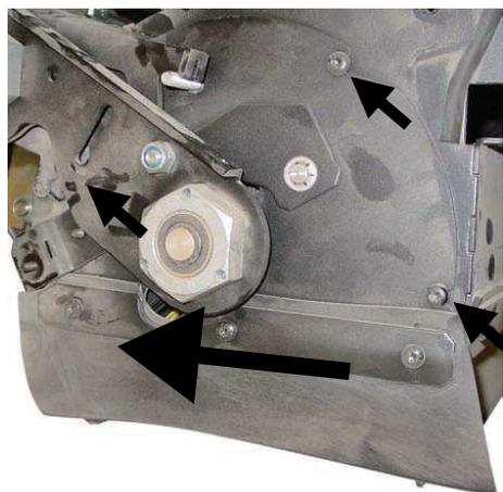
側面カバーセットを前方に10 mmほどずらしロックピン(←)を解除します。
