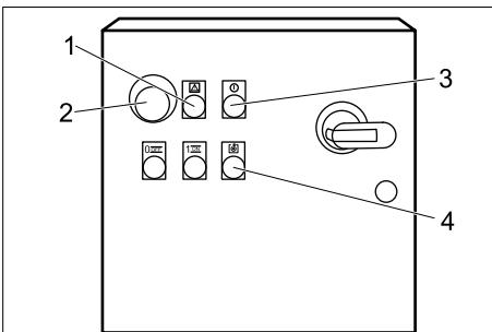
1 Indikator aktiviranog prekidača za isključenje u nuždi
