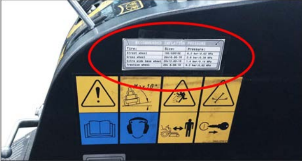
Şekil: Sürücü kabini içinde tavsiye edilen lastik basınçlarının yazıldığı etiket
