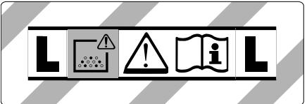
**UPOZORENJE:** Ovaj uređaj sadrži prašinu koja je štetna po zdravlje. Pražnjenje i održavanje uređaja, uključujući i uklanjanje vrećice s prašinom, smeju izvoditi samo stručnjaci koji nose odgovarajuću zaštitnu opremu. Ne uključujte pre nego što se ugradi kompletan filtracioni sistem.
