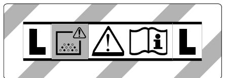
**OSTRZEŻENIE:** Urządzenie zawiera szkodliwe dla zdrowia pyły. Opróżnianie i konserwacja, włącznie z usuwaniem worka pyłowego, mogą być przeprowadzane jedynie przez osoby odpowiednio przygotowane, noszące właściwe osobiste wyposażenie ochronne. Nie włączać przed całkowitym zainstalowaniem systemu filtracyjnego.
