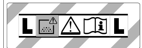
**ΠΡΟΕΙΔΟΠΟΙΗΣΗ:** Η συσκευή αυτή περιέχει σκόνη βλαβερή για την υγεία Η εκκένωση και η συντήρηση, συμπεριλαμβανομένης της αφαίρεσης της σακούλας σκόνης, πρέπει να εκτελούνται μόνο από ειδικούς, οι οποίοι χρησιμοποιούν κατάλληλο προσωπικό εξοπλισμό προστασίας. Να μην ενεργοποιηθεί, πριν εγκατασταθεί ολόκληρο το σύστημα φίλτραρίσματος.
