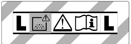
**WARNUNG:** Dieses Gerät enthält gesundheitsgefährliche Stäube. Entleerung und Wartung, einschließlich der Entfernung des Staubbeutels, dürfen nur von sachkundigen Personen vorgenommen werden, die geeignete persönliche Schutzausrüstung tragen. Nicht einschalten, bevor das komplette Filtersystem installiert ist.
