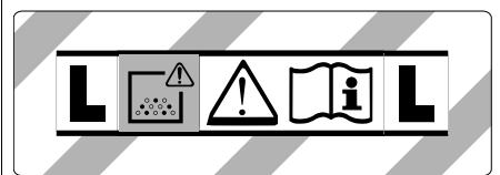
**ATTENZIONE:** Questo apparecchio contiene polveri nocive alla salute. Le operazioni di svuotamento e di manutenzione, inclusa la rimozione del sacchetto della polvere possono essere eseguite solo da personale specializzato indossando un equipaggiamento adatto alla protezione personale. Non attivare prima della completa installazione del sistema di filtraggio.
