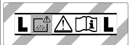
*ADVERTÊNCIA: este aparelho contém pós nocivos para a saúde. O esvaziamento e manutenção, incluindo a eliminação do saco do pó, só podem ser realizados por pessoas qualificadas que utilizem equipamento de protecção pessoal adequado. Não ligar enquanto o completo sistema de filtração não estiver instalado.*
