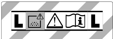
**OPOZORILO:** Ta naprava vsebuje vrste prahu, ki so zdravju nevarne. Praznjenje in vzdrževanje, vključno z odstranjevanjem vrečke za prah, smejo izvajati le strokovne osebe, ki nosijo ustrezno osebno zaščitno opremo. Ne vklopite, preden ni instaliran celoten filtrski sistem.
