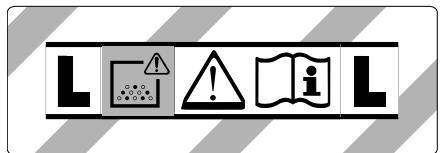
**VARNING:** Maskinen innehåller hälsovådligt damm. Tömning och underhåll, inklusive avlägsnande av dammpåsen, får endast utföras av en sakkunnig person som bär lämplig personlig skyddsutrustning. Starta inte maskinen innan det kompletta filersystemet har installerats.
